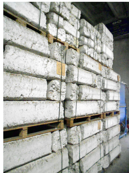
Fig. 2. Prodotto finale dal trattamento termico di riduzione degli scarti di polistirolo espanso (foto di A. Monsù Scolaro)
